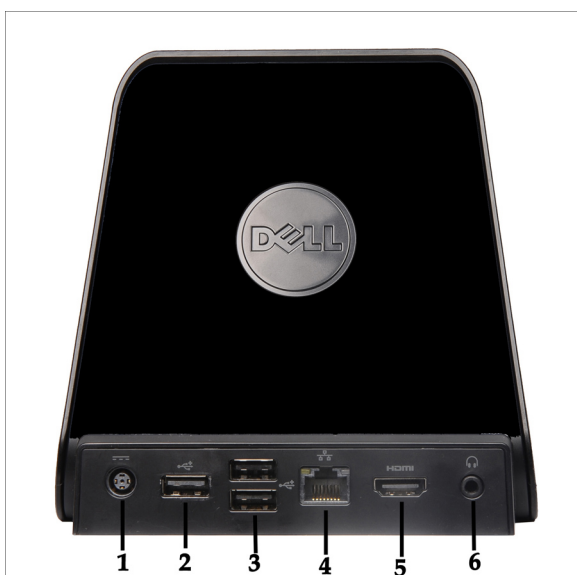
Slika 2. Pogled sa stražnje strane na priključnu stanicu
